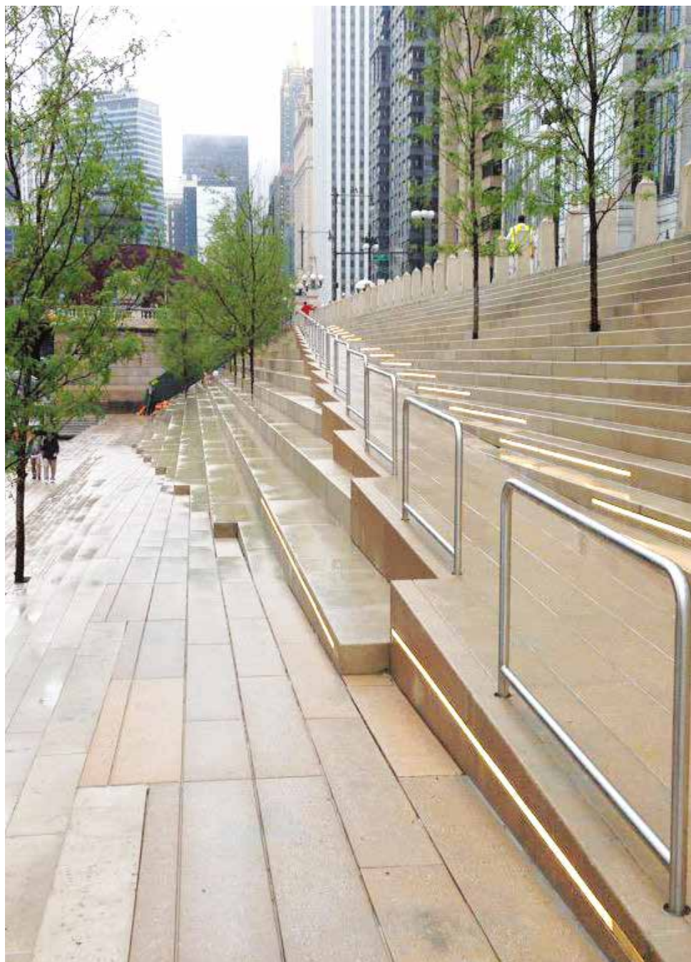
Figura 32 - Combinazione di scala e rampa interconnesse (stramp).
